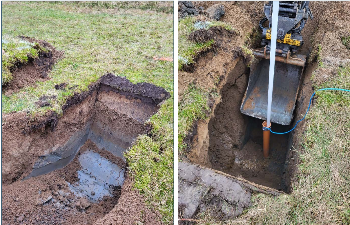
Figur 6. PG2309 (tv) med fyllning (sand) på naturligt avsatt lera. PG2308 (th) som visar installation av grundvattenrör.
