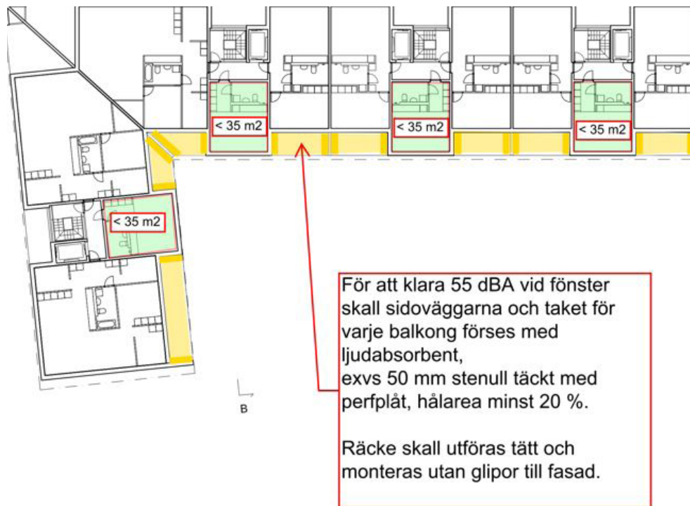
Illustration av teknisk lösning med absorbenter vid balkong.
