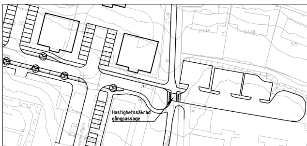
Figur 12 Utsnitt ur trafikutformningsförslaget vid Östergårdsskolan. Förslaget visar en lösning där en personbil kan vända utan att korsa gång- och cykelbanan. Förslaget förutsätter att renhållningsfordon fortsatt löser vändmöjlighet på kvartersmark vid Östergårdsskolan.
