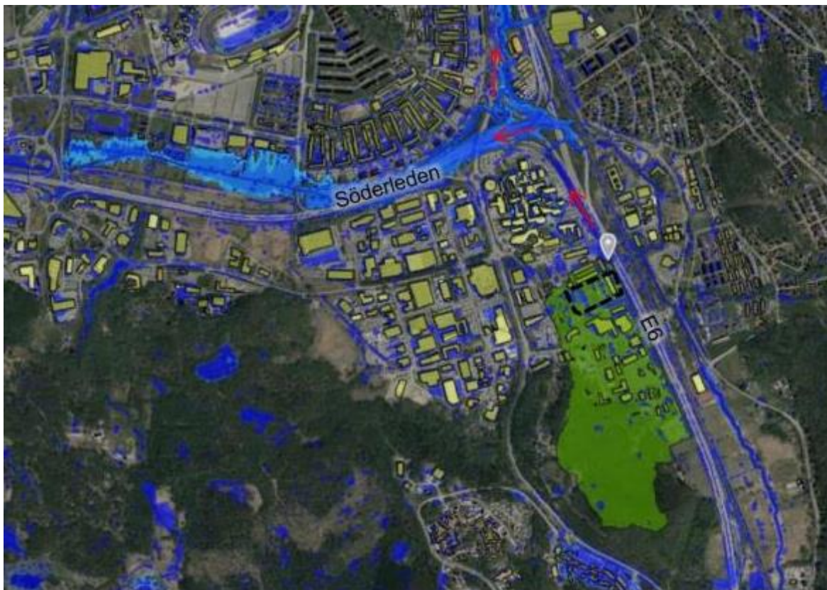
Figur 13.5. Ytvavrinningsvägar från aktuellt område (röda pilar) vid kraftig nederbörd när ledningsnätet går fullt och ytor samt de ytor som då riskerar översvämmas (Sweco 2019c).
