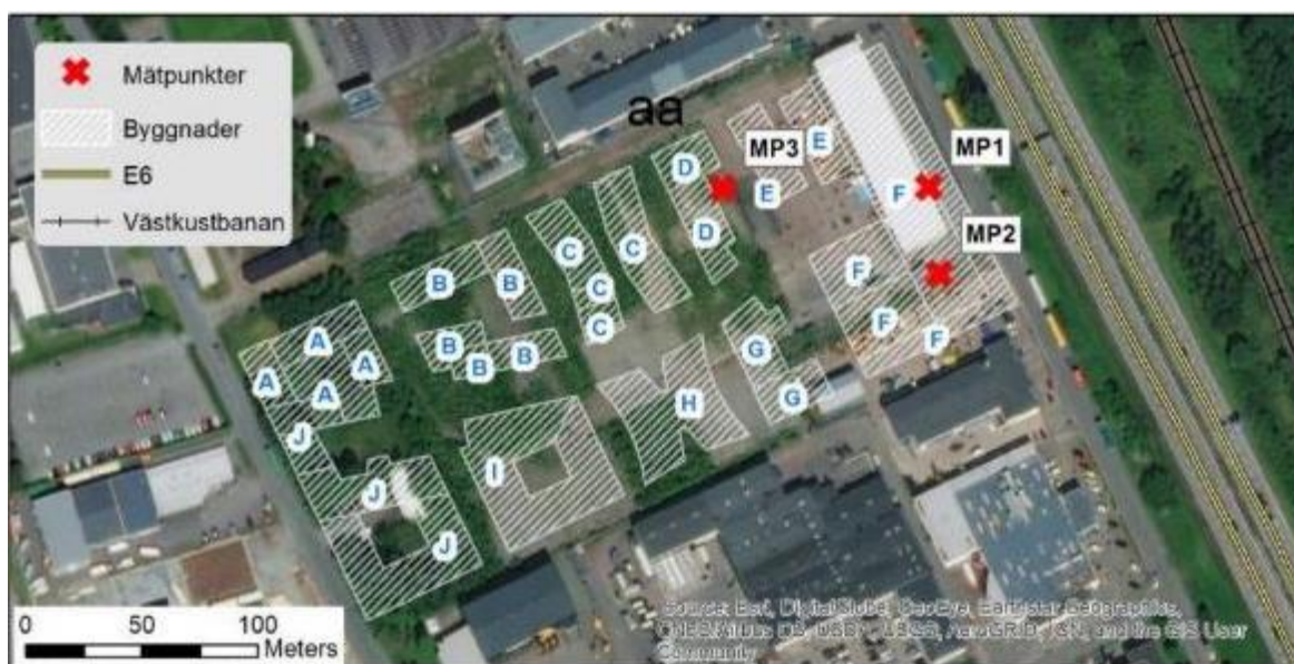
Figur 11.1. Mätpunkter för vibrationsmätning (MP1-MP3) inom aktuellt planområde.
