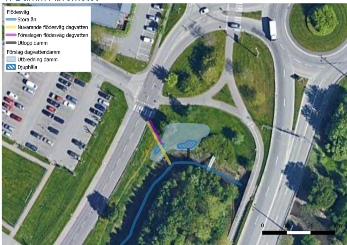
Figur 19. Åtgärdsförslag 1 – Damm Åbromotet.
