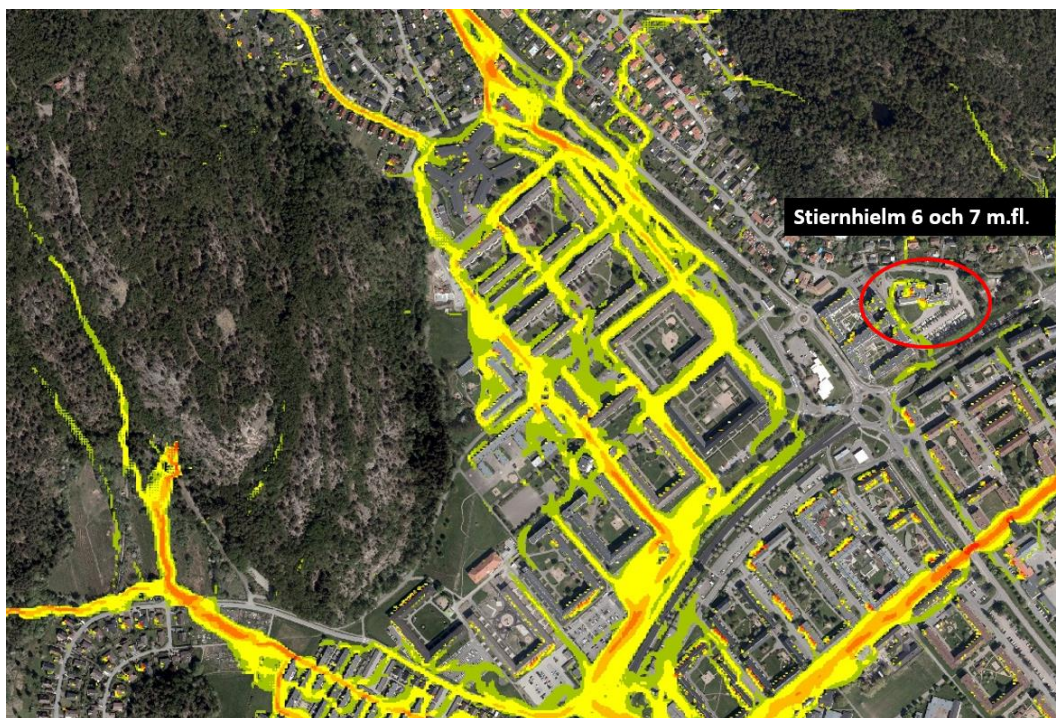
Figur 3. Flödesvägar vid ett klimatanpassat 100-årsregn, vid befintlig situation (nuläge). Röda ytor visar höga flöden och gröna ytor visar lägre flöden. Detaljplaneområde Stiernhielm 6 och 7 m.fl. (rödmarkerat).
