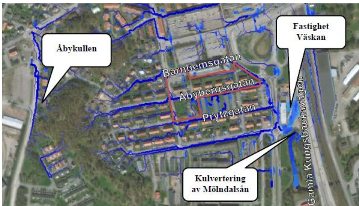
Ytliga rinnvägar och områden med stående vattenmassor, Dagvattenutredning, Markera.
